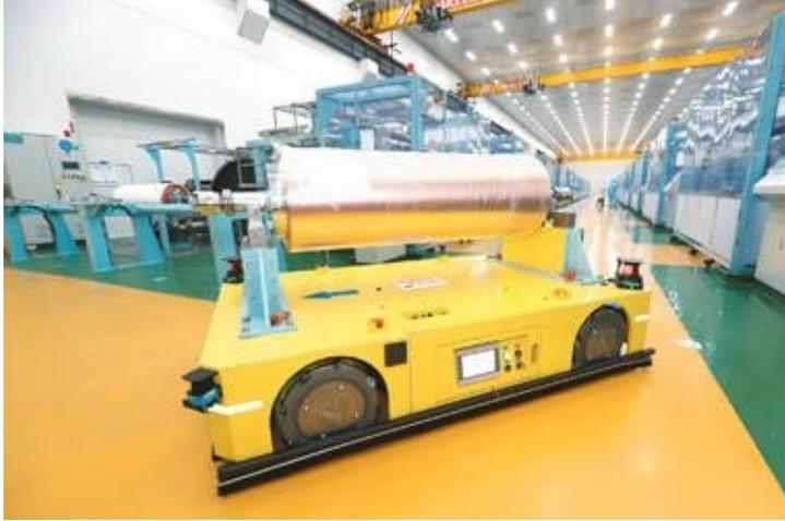
图为在浙江花园新能源股份有限公司铜箔生箔车间内,自动导引车(AGV)正在协助生产车间完成自动取放卷及跨车间转运成品等。包康轩 摄(人民视觉)
