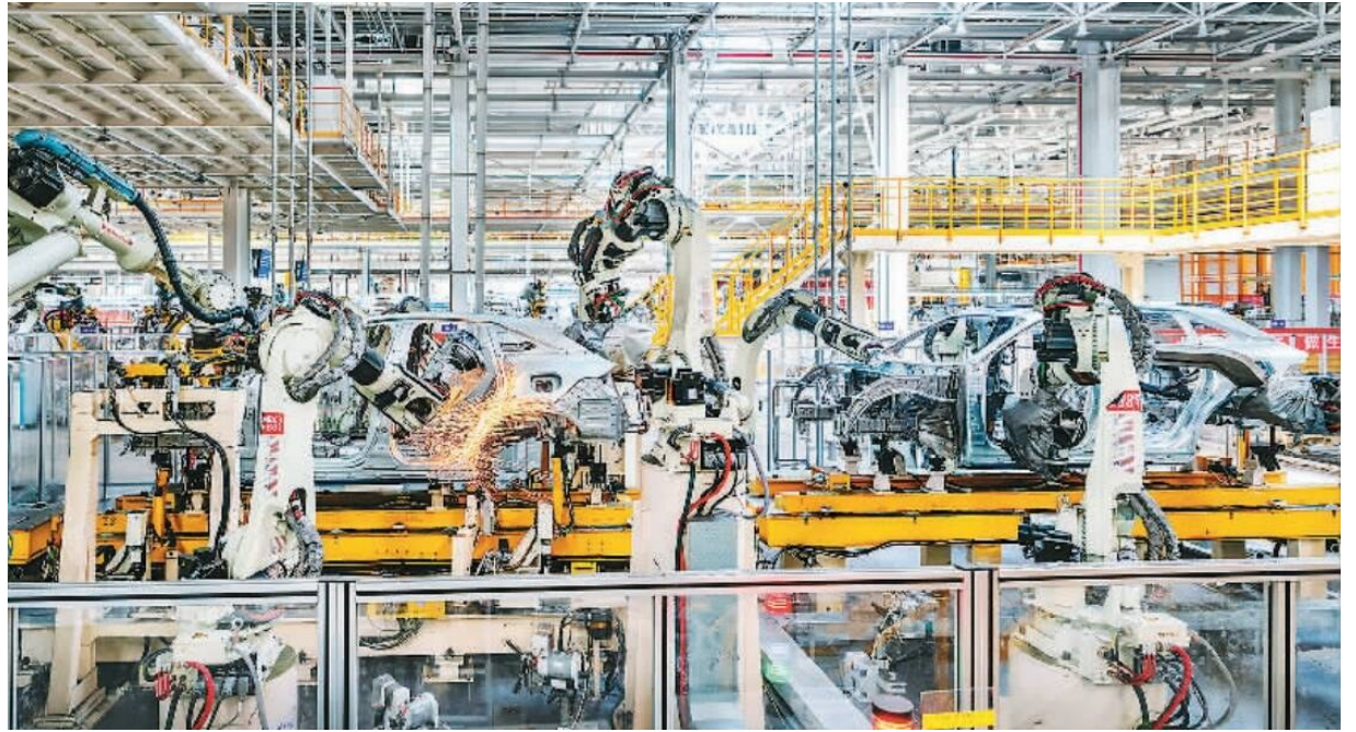
位于江苏省南京市溧水区的南京长安汽车新工厂自动化生产车间内,机械手臂正灵活焊接组装新能源汽车。 朱红生摄(人民图片)
